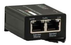
Die Geräte der Serie VI-UTP-2300A übertragen 10/100Mbps Ethernet und PoE/PoE+ mit UTP, bzw. Cat-Kabel bis zu einer Distanz von 500m. Die Pass Through Technologie ermöglicht es, die PoE Speisung z.B. eines Midspans direkt über UTP, bzw. Cat-Kabel weiterzugeben. Die Geräte brauchen keine Software-Konfiguration. Diagnose LEDs dienen der Übersicht des Betriebzustandes. Die Module der Serie VI-UTP-2300A sind als Tischmodelle, auf Hutschiene und in 19"-Schränken montierbar.
