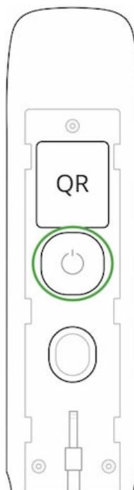
Gerät innerhalb der Funkreichweite der Hub-Zentrale und im selben geschützten Objekt befinden. Eine Verbindungsanforderung an die Hub-Zentrale wird nur beim Einschalten des Gerät gesendet.
