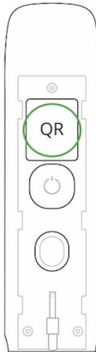
3. Schalten Sie das Gerät ein, indem Sie den Netzschalter 3 Sekunden lang gedrückt halten.
