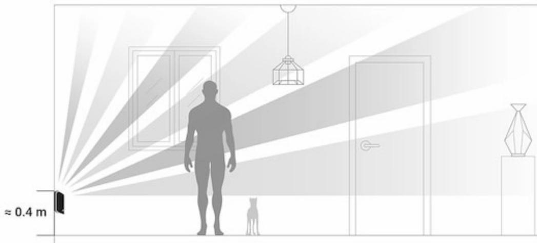
Der Montageort des MotionProtect Curtain hängt vom Abstand zur Hub-Zentrale und von Hindernissen zwischen den Geräten ab, die das Funksignal stören können: Wände, Böden, massive Gegenstände im Raum.
