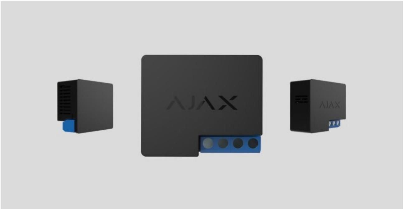
**Relay** ist ein fernsteuerbares Niederspannungsrelais mit potentialfrei (trocken) schaltenden Kontakten. Das Gerät zum fernbetätigten Ein-/Ausschalten von Geräten kann mit Steuerspannungen von 7 bis 24 V= geschaltet werden. Relay kann sowohl im Impulsmodus als auch im bistabilen Modus betrieben werden. Das Gerät kommuniziert über das Jeweller-Funkprotokoll mit einer Hub-Zentrale. In Sichtlinie beträgt die Übertragungreichweite bis zu 1000 m.
