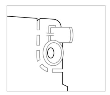
**5.** Schieben Sie das KeyPad Plus auf die Halteplatte und ziehen Sie die Schraube an der Unterseite des Gehäuses fest. Diese wird benötigt um die Tastatur sicherer zu befestigen und vor schnellem Entfernen aus der
