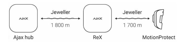
Die Übertragungsreichweite zwischen ReX und dem Gerät wird durch die Funkreichweite des Geräts begrenzt (siehe Technische Daten des Geräts auf der Website und im Benutzerhandbuch).
