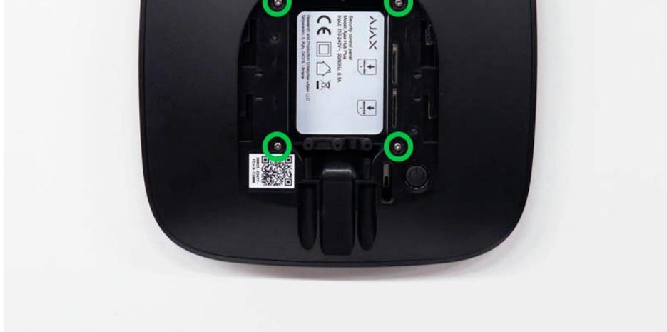
5. Entfernen Sie die Schrauben, mit denen die Platinen am Gerätegehäuse befestigt sind.
